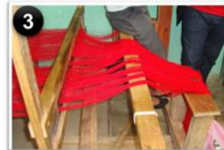
3 Colocar nudos en la barra y amarrarlos
