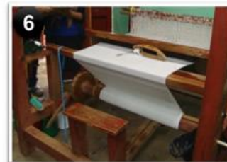
6 Aplicar presión y posicionar. Realizar cambio de pedal y repetir procedimiento
